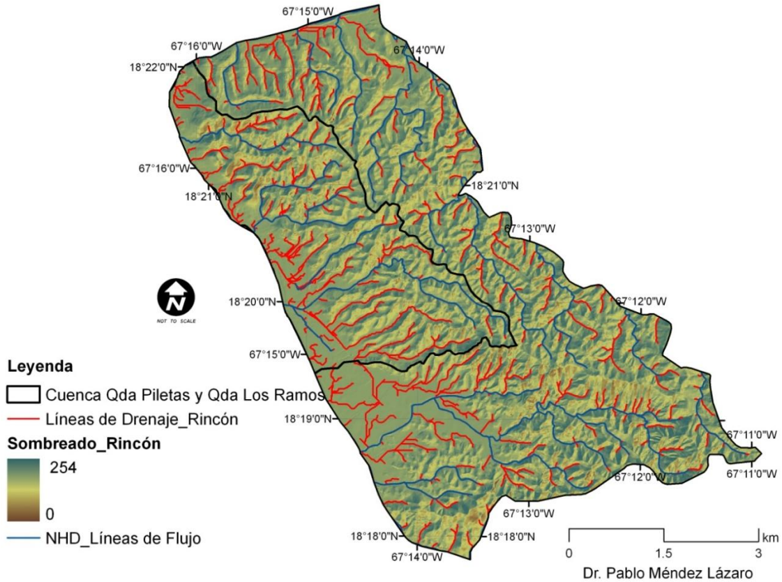
Figura 6. Ríos, quebradas y áreas de drenaje intermitentes contruidos con HEC-tool v.5.0. Fuente: Elaboración propia
